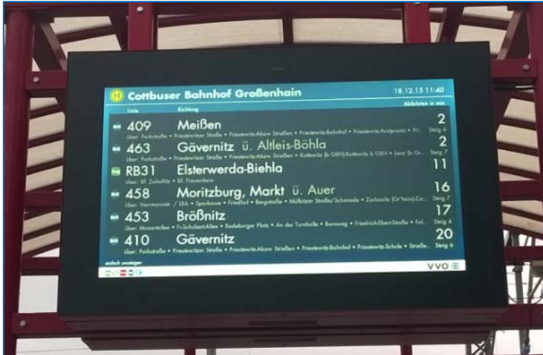
Foto 10: Dynamische Fahrgastinformation in Großenhain, Cottbuser Bahnhof
